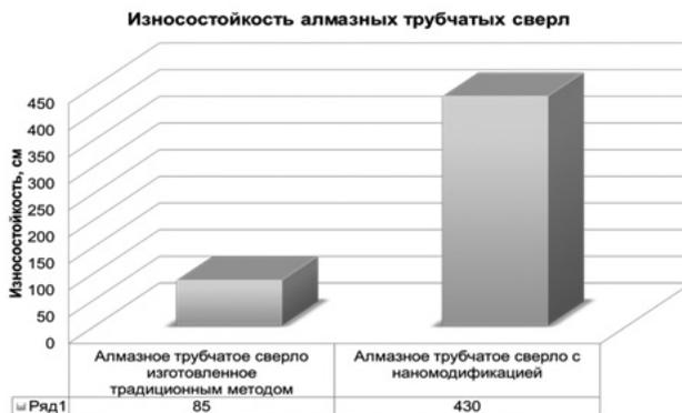
Рис. 3. Износостойкость алмазных трубчатых сверл
