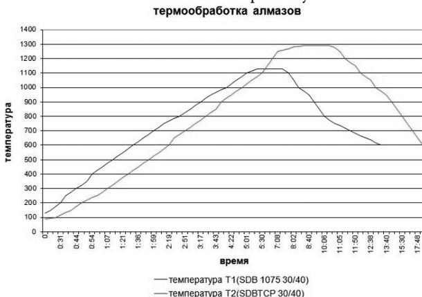
Рис. 1. (Вкладка: стр. II, рис. 11) График временного хода нагрева навески порошков алмазов: время в минутах, T °C
