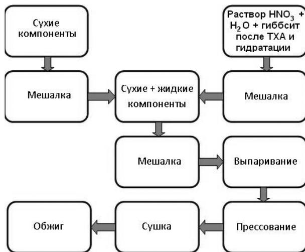
Рис. 4. Схема приготовления керамических образцов (таблеток)
