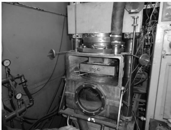
*Фото 1. Камера пресса горячего прессования с установленной пресс-формой*
