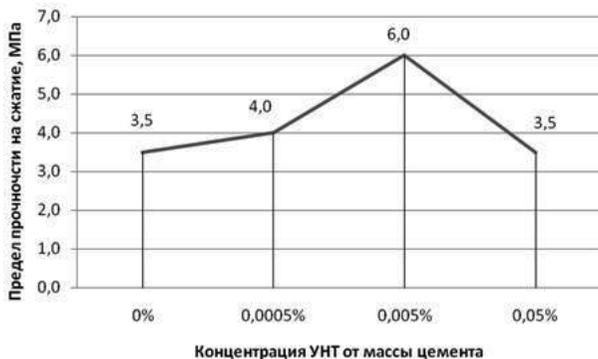
Рис. 1. График зависимости прочности газобетона в зависимости от количества вводимого наномодификатора
