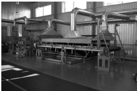
Рис. 5. Линия по производству листовых огнезащитных материалов «Огракс» (г. Климовск)
