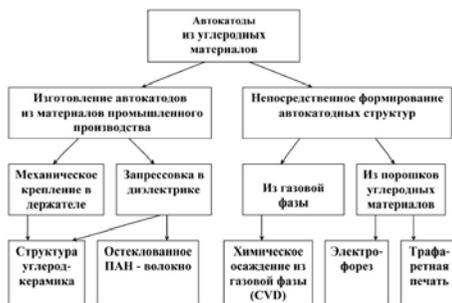
*Рис. Классификация основных методов изготовления автокатодов из углеродных материалов*
